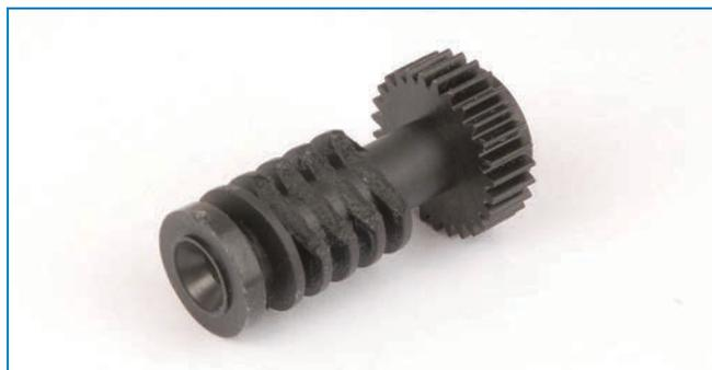
Défaillance des vis sans fin à cause d'un mécanisme VNT restreint.
