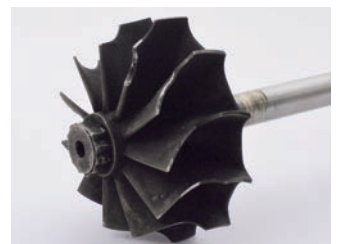
Défaillance de la roue de turbine en HCF
