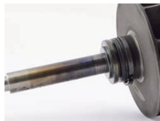
Transfert de chaleur du côté de la turbine
