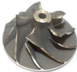
Éclats sur les pales du compresseur
