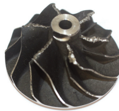
Corrosion autour de l'entrée du compresseur
