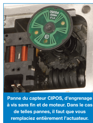
Panne de l'engrenage à vis sans fin à cause d'un mécanisme de géométrie restreint
