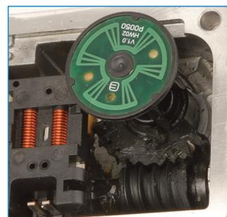
Panne du capteur CIPOS, d'engrenage à vis sans fin et de moteur. Dans le cas de telles pannes, il faut que vous remplaciez entièrement l'actuateur.
