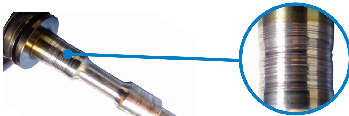
Rayures sur l'axe au niveau du palier
